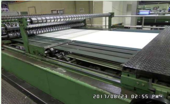
종이 재단기 내 설치된 벨트컨베이어
